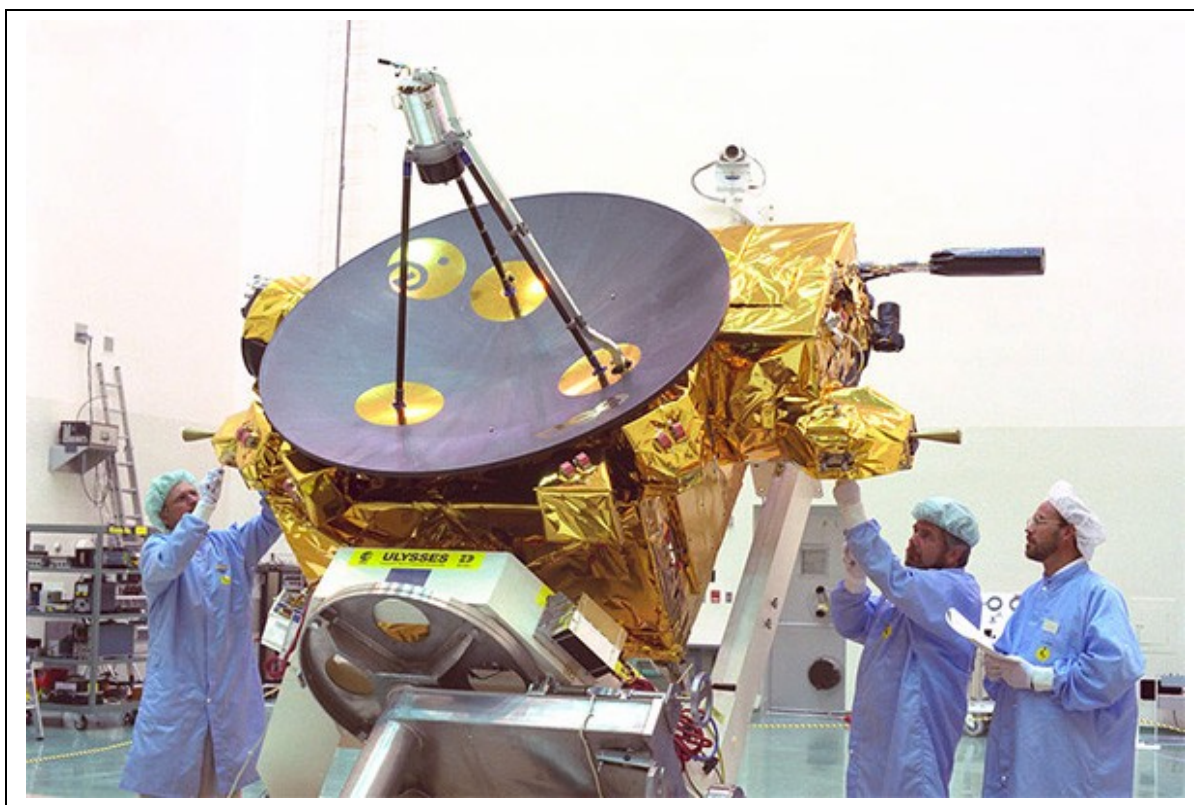
Предполетная подготовка «Улисса», космодром на мысе Канаверал (США). Большая антенна (диаметром 1,65 м) была необходима зонду для связи с Землей на расстояниях вплоть до 950 млн км, а термозащитное покрытие — чтобы противостоять огромным перепадам температур. Фото с сайта www.esa.int
